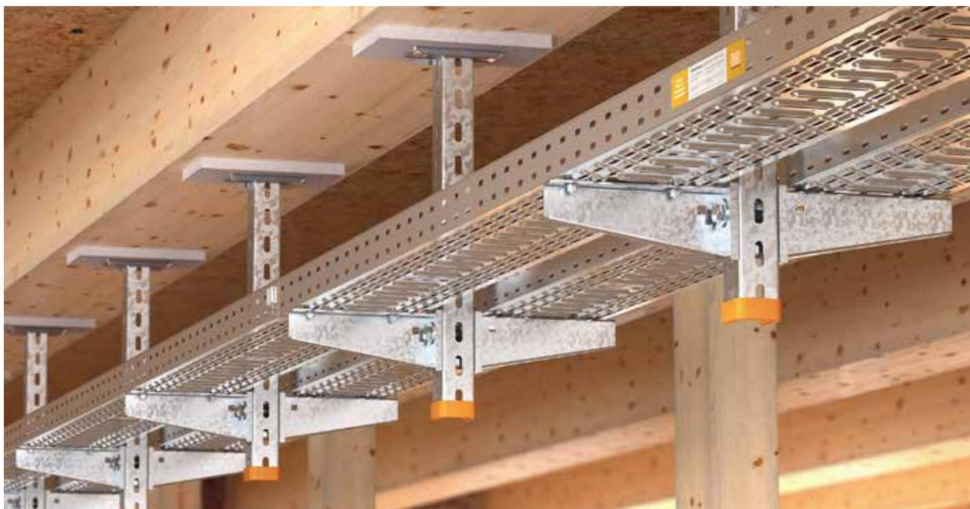
Gelochte Brandschutzplatte als wirksame Bekleidungsmaßnahme für die Befestigung an tragenden Holzbauteilen für den Funktionserhalt nach DIN 4102 Teil 12. Bestehend aus wasser- und frostbeständigem Glasfaserleichtbeton (Baustoffklasse A1 - nicht brennbar).
