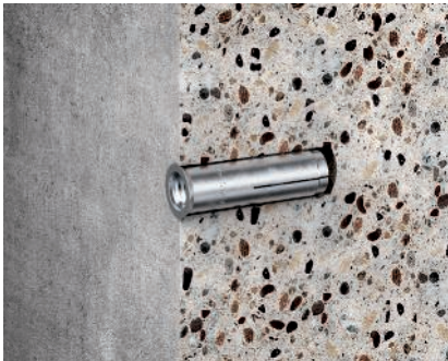
Einschlaganker Typ ES Einschlaganker Typ E mit Innengewinde M6, M8, M10, M12. Zur Aufnahme kleinerer Lasten, zugelassen für Mehrfachbefestigungen in gerissenem und ungerissenem Beton von nichttragenden Systemen.
