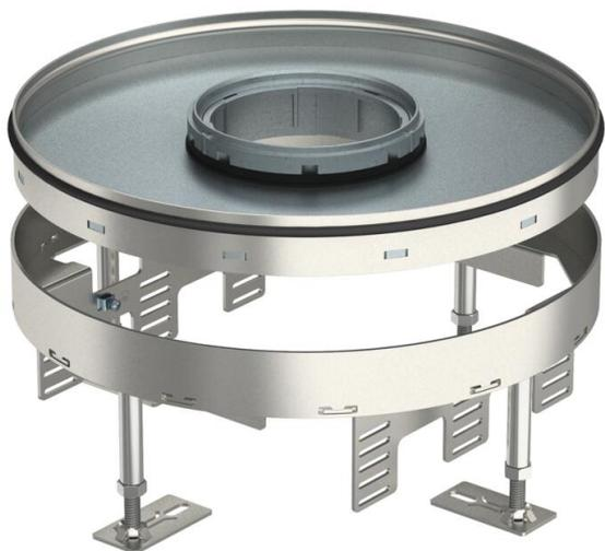
Nivellierbare Kassette der Nenngröße R9 für Tubus für den Einbau von Installationsgeräten in trocken oder nass gepflegten Fußböden im Innenbereich. Nivellierbare Kassette mit Tubus, 3-zügig. Es können 3 Abdeckplatten APMT5 installiert werden. Für den Einbau von 3 Universalträgern UT4 für 9 Einzel-Installationsgeräte mit Tragering/Tragebügel oder 12 Modul 45-Geräte. Der Tubus ist nicht im Lieferumfang enthalten.
