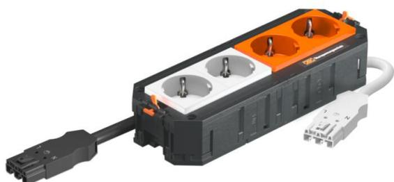
Der anschlussfertige Universalträger UTC4 verfügt über 2 vorinstallierte 33°-Schutzkontaktsteckdosen in weiß und über 2 vorinstallierte 33°-Schutzkontaktsteckdosen in orange (mit Überspannungsschutzmodul Typ 3 nach DIN EN 61643-11), 250 V~ 16 A. Passend zu den Verbindungsleitungen VL und den Geräteeinbaueinheiten der Nenngröße R7, R9 und 9.
