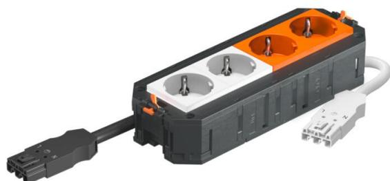
Der anschlussfertige Universalträger UTC4 verfügt über 2 vorinstallierte 33°-Schutzkontaktsteckdosen in weiß und über 2 vorinstallierte 33°-Schutzkontaktsteckdosen in orange, 250 V~ 16 A. Passend zu den Verbindungsleitungen VL und den Geräteeinbaueinheiten der Nenngröße R7, R9 und 9.
