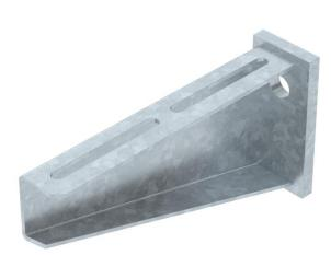
Schwerer Wandausleger mit angeschweißter Kopfplatte. Bei der Befestigung von Kabelrinnen- und leitern mit Flachrundschrauben der Größe M6 bitte Großflächenscheibe separat bestellen (Lochung im Ausleger 9 x ...).
