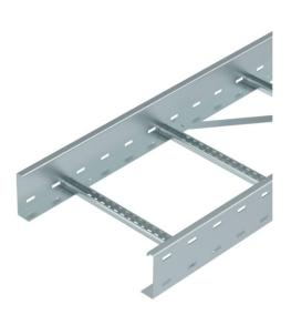
Weitspann-Kabelleiter mit gelochtem Seitenholm in 110 mm Seitenhöhe. Befestigung von Kabeln und Leitungen mit Bügelschelle Typ 2056. Längsverbinder Typ WRVL 110 sind anteilig separat zu bestellen. Magnetische Schirmdämpfung ohne Deckel 10 dB, mit Deckel 15 dB.
