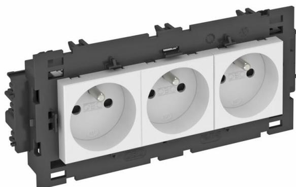
Erdungsstift-Steckdose mit seitlichem Anschluss 3-fach 0°, mit erhöhtem Berührungsschutz, mit Steckklemmen, 2-polig, 16 A, 250 V~, mit Verbindungsklemmen nach IEC 60884-1, geeignet für den Einbau in Geräteeinbau-Kanalsysteme Rapid 80.
