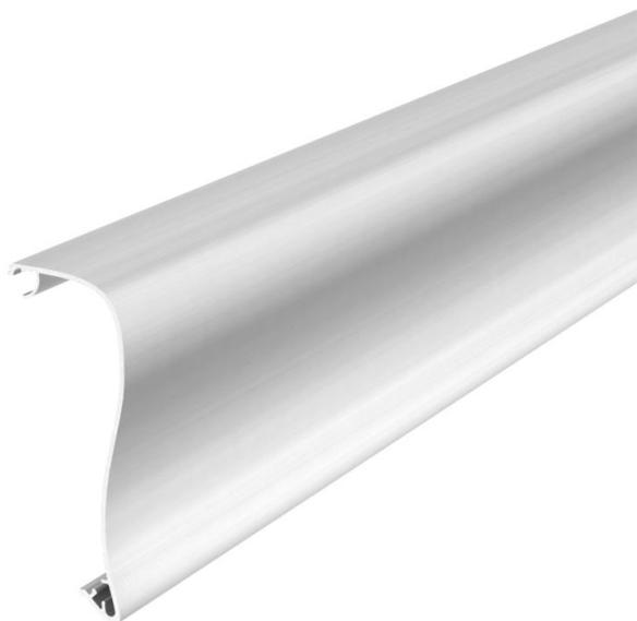
Kanalabdeckung zur Erstellung eines Design-Geräteeinbaukanals der Serie GAD. Designausführung "Swing" zur vollständigen Abdeckung der Systemöffnung und der Schalt- und Steckgeräte. Die Oberteiladapter GAD OTA sind zwingend erforderlich und sollten im max. Abstand von 50 cm auf der Kanalstrecke eingeplant werden. Zwischen den Kanalabdeckungen muss ein Distanzstück GAD OTD gesetzt werden.
