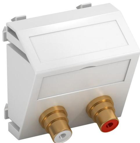
Multimediaträger mit zwei Cinch Anschlussbuchsen für Audio R / L, Kabelausslass schräg, mit Beschriftungsfeld, zwei Cinch Buchsen (RCA) mit Lötanschluss, Farbkodierung rot / weiß. Trägerplatte mit Rastbefestigung, geeignet für den waagerechten und senkrechten Einbau in die Systemumgebung.
