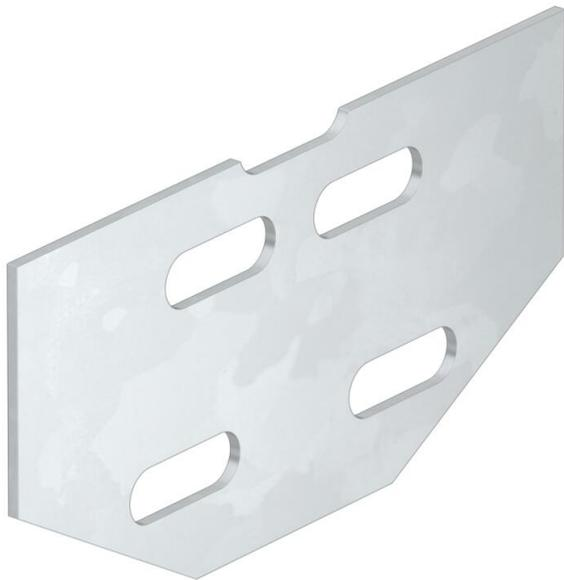
Der Längsverbinder vertikal kann für die Längsverbindung von Kabelrinnen mit der Seitenhöhe 60 mm eingesetzt werden. Gehrungsverbindungen steigend und fallend bis zu einem Winkel von 60° sind ebenfalls mit diesem Verbinder realisierbar. Die Durchgängigkeit des Potentialausgleich ist durch die Verschraubung sichergestellt.
