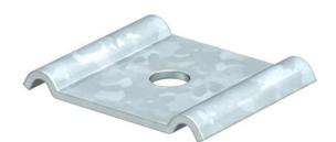
Klemmstück zur Befestigung von Gitterrinnen auf dem Boden oder auf Distanzbügeln Typ DBL. Einsatz nur bei Gitterrinnen mit 50 x 100 mm Maschenweite.
