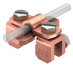
• Blechstärke bis 10 mm • Leitungsführung quer und längs zum Blech mit 2 Sechskantschrauben M8 x 10 und 2 Sechskantschrauben M8 x 16 (F) • 273 Cu: mit Sechskantschrauben aus rostfreiem Stahl (VA)
