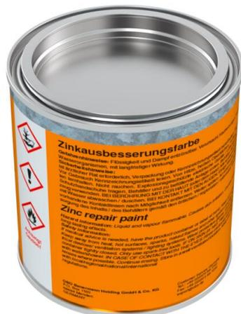
Zinkausbesserungsfarbe für Fehlstellen an feuerverzinkten Stahlteilen, zum Beseitigen von Schleif- und Schweißschäden an der Verzinkung sowie zum Anpassen nicht verzinkter Kleinteile an verzinkte Konstruktionen.
