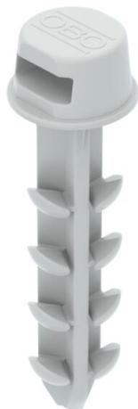
Steckdübel zur Montage in der Elektroinstallation. Geeignet für Beton, Kalksandstein, Vollziegel, Hohllochziegel und Porenbeton. Werkzeuglose Montage durch Eindrücken in Bohrloch an Wand oder Decke. Ohne Schrauben. Mit Kabelbinderaufnahme bis 4,8 mm Breite zur Befestigung von Kabeln und Rohren.
