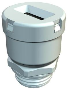
Flachkabeleinführung in Würgenippelbauart, mit metrischem Anschlussgewinde nach IEC 432, Schutzart IP 31, mit vormontiertem Stutzendichtring 107/F.
