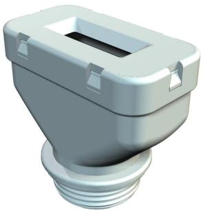
Flachkabeleinführung in Würgenippelbauart, mit PG-Anschlussgewinde nach DIN 40430, Schutzart IP31, mit vormontiertem Stutzendichtring 107/F.
