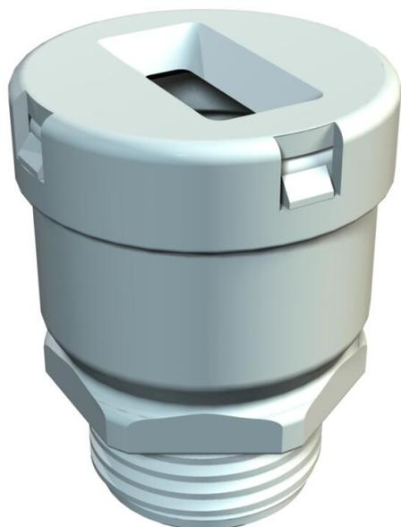
Flachkabeleinführung in Würgenippelbauart, mit PG-Anschlussgewinde nach DIN 40430, Schutzart IP31, mit vormontiertem Stützendichtring 107/F.
