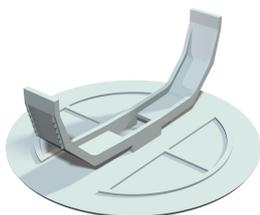
Federdeckel mit zentrisch angespritzter elastischer Spreizfeder, für Dosen mit  $\varnothing$  60 mm, Deckelrand liegt plan auf, Oberfläche ist aufgeraut.
