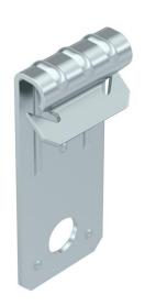
Trägerklammer mit Bohrung für individuelle Montagelösungen, z. B. für die Aufnahme von S-Haken oder Ketten. Befestigung an Stahträgern durch Aufschlagen.
