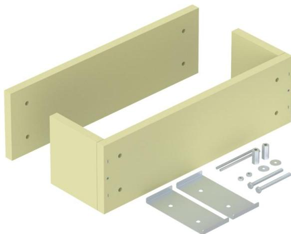
Zugentlastung als wirksame Unterstützungsmaßnahme für senkrechte Kabelverlegung nach DIN 4102 Teil 12. Zugelassen für alle Kabeltypen und Steigeleitern, die als hängende Montage ausgeführt werden. Funktionserhaltklassen E30 bis E90. Leeres Gehäuse zur individuellen Füllung mit Brandschutzschaum PYRO-SIT® NG und/oder Schaumstoffblöcken PYROPLUG® Block, inkl. Montageset und Kennzeichnungsschild.
