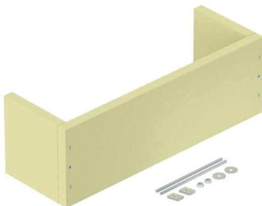
Zugentlastung als wirksame Unterstützungsmaßnahme für senkrechte Kabelverlegung nach DIN 4102 Teil 12. Zugelassen für alle Kabeltypen und Verlegesysteme, die direkt an Massivwänden montiert werden. Funktionserhaltklassen E30 bis E90. Leeres Gehäuse zur individuellen Füllung mit Brandschutzschaum PYROSIT® NG und/oder Schaumstoffblöcken PYROPLUG® Block, inkl. Montageset und Kennzeichnungsschild.
