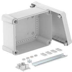
Kabelabzweigkasten mit Hutprofilschiene zum Verbinden von Kabeln und Leitungen im Innen- und Außenbereich. Rechteckige Form ohne Einführungen. Geeignet für die Wand-/ Deckenmontage mit der Möglichkeit zur Außenbefestigung, Innenbefestigung oder Montage über die Eckdome. Besonders schlagfest mit IK09. Deckel mit Schnellverschluss, plombierbar. Hergestellt aus halogenfreien und UV-resistenten Materialien.
