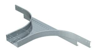
Anbau-Abzweigstück für den horizontalen Einsatz. Für alle Weitspannkabelrinnen mit der Seitenhöhe 110 mm. Zur weiteren Stabilisierung sollten im Bereich der Formteile Unterstützungen vor-
