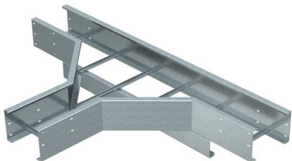
T-Stück, horizontal, für alle Weitspannkabelleitern mit der Seitenhöhe 200 mm. Zur weiteren Stabilisierung sollten im Bereich der Formteile Unterstützungen vorgesehen werden.
