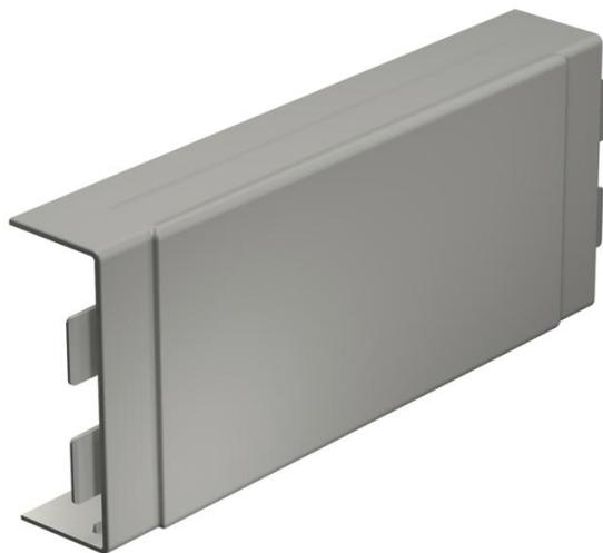
T- und Kreuzstückhaube zur Richtungsänderung der WDK-Kanäle. Das Formteil ist für den Anschluss unterschiedlicher Kanalquerschnitte seitlich vorperforiert.
