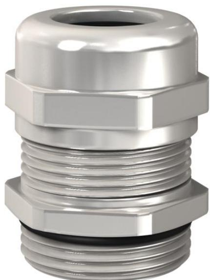
Robuste EMV Kabelverschraubung mit metrischem Anschlussgewinde nach IEC 423 in Hutmutterbauart für hohe Dichtigkeitsansprüche. Die Kontaktierung zwischen Verschraubung und Schirmgeflecht erfolgt über eine Kontaktfeder. Zugentlastung, Verdrehenschutz und Dichtigkeit über den gesamten Spannungsbereich. Dichtung aus Neopren. Klemmeinsatz aus Polyamid. Mit vormontiertem O-Dichtring am Anschlussgewinde, VDE-geprüft nach DIN EN 50262, Schutzart IP68 bei 5 bar/1 h.
