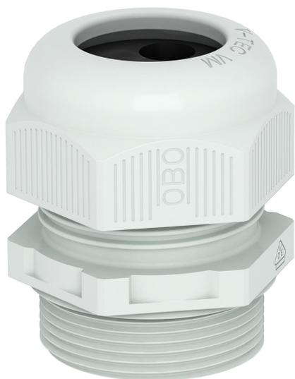
Kabelverschraubung mit metrischem Anschlussgewinde in Hutmutterbauart, für Kabelabzweiggästen, Gehäuse, Verteilerschränke im privaten und industriellen Bereich. Mit Zugentlastung und integrierter Dichtlippe, geprüft nach DIN EN 62444. Schutzklasse IP68. Einsetzbar von -20°C bis +65°C.
