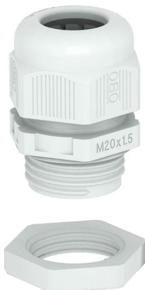
Kabelverschraubung mit metrischem Anschlussgewinde in Hutmutterbauart, für Kabelabzweiggkästen, Gehäuse, Verteilerschränke im privaten und industriellen Bereich. Mit Zugentlastung und integrierter Dichtlippe, geprüft nach DIN EN 62444. Schutzklasse IP68. Einsetzbar von -20°C bis +65°C. Inklusive Gegenmutter.
