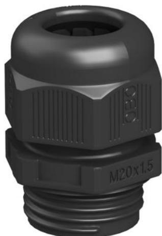
Kabelverschraubung mit metrischem Anschlussgewinde in Hutmutterbauart, für Kabelabzweigkästen, Gehäuse, Verteilerkästen im privaten und industriellen Bereich. Mit Zugentlastung und integrierter Dichtlippe, geprüft nach DIN EN 62444. Schutzklasse IP68. Einsetzbar von -20°C bis +65°C.
