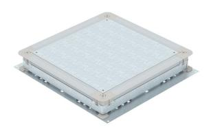
Unterflur Zug- und Abzweigdose für estrichüberdeckte Unterflur-Installationskanäle mit Seitenwänden aus Stahlblech. Zur Montage von Einbaueinheiten in Montagedeckel (separat zu bestellen). Lässt sich stufenlos auf Estrichnennhöhe nivellieren (Schnellnivellierung möglich) und der Estrich kann bündig an die Estrichabzugskante angearbeitet werden. Mit schalltechnischer Entkopplungsmöglichkeit nach Estrichverlegung und mit Systemzubehör auch für Schwerlastanwendung verwendhar.
