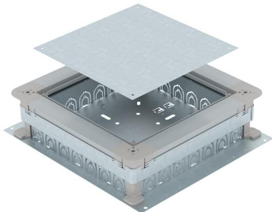
Unterflur Zug- und Abzweigdose für je 7 Installationsrohre pro Seite (M20 oder M32) mit Seitenwänden aus Stahlblech. Zur Montage von Einbaueinheiten in Montagedeckel (separat zu bestellen). Lässt sich stufenlos auf Estrichnennhöhe nivellieren (Schnellnivellierung möglich) und der Estrich kann bündig an die Estrichabzugskante angearbeitet werden. Mit schalltechnischer Entkopplungsmöglichkeit nach Estrichverlegung und mit Systemzubehör auch für Schwerlastanwendung verwendbar.
