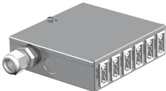
Energieverteiler für Starkstromtechnik mit Festanschluss, bestückt und vorverdrahtet. Eingang: 1 Drehstromkreis über einen schraubenlosen Steckklemmblock 5-polig für Leitungsquerschnitte 0,5 - 4 mm<sup>2</sup>. Ausgang: 6 selbstverriegelnde Steckverbinder 3-polig in weiß, 16 A, Typ GST18i (Buchse: 2 x L1, 2 x L2, 2 x L3). Verdrahtung intern: PVC-Aderleitung H07V-U2,5.
