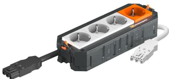
Der anschlussfertige Universalträger UTC4 verfügt über 3 vorinstallierte 33°-Schutzkontaktsteckdosen in weiß und eine vorinstallierte 33°-Schutzkontaktsteckdose in orange (mit Überspannungsschutzmodul Typ 3 nach DIN EN 61643-11), 250 V~ 16 A. Passend zu den Verbindungsleitungen VL und den Geräteeinbaueinheiten der Nenngröße R7, R9 und 9.
