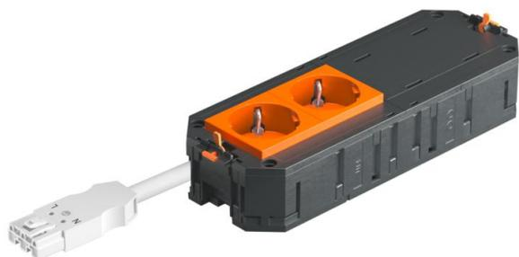
Der anschlussfertige Universalträger UTC4 verfügt über 2 vorinstallierte 33°-Schutzkontaktsteckdosen mit 16 A und 2 Blindabdeckung für den nachträglichen Einbau von 2 Installationsgeräten der Modul45. Passend zu den Verbindungsleitungen VL und den Geräteeinbaueinheiten der Nenngröße R7, R9 und 9.
