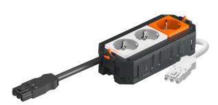
Der anschlussfertige Universalträger UTC3 verfügt über 2 vorinstallierte 33°-Schutzkontaktsteckdosen in weiß mit 16 A und eine vorinstallierte 33°-Schutzkontaktsteckdosen in orange mit 16 A. Passend zu den Verbindungsleitungen VL und den Geräteeinbaueinheiten der Nenngröße 2, 4, R4, 6 und R7.
