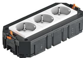
Der anschlussfertige Universalträger UTC3 verfügt über drei vorinstallierte 33° Schutzkontakt-Steckdosen mit 16 A. Passend zu den Verbindungsleitungen VL und den Geräteeinbaueinheiten der Nenngröße 2, 4, R4, 6 und R7.
