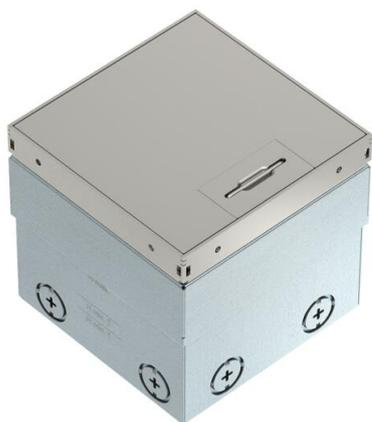
Quadratische Bodensteckdose für den Einsatz in trocken gepflegten Holzböden und Estrichböden im Innenbereich. Einbaugehäuse mit vorgeprägten Einführungsöffnungen für Rohre (M20/M25). Oberteil durch 4 Nivellierstützen auf Oberkante Bodenbelag einstellbar. Die Mindesteinbautiefe beträgt 100 mm, der Nivellierbereich + 35 mm.
