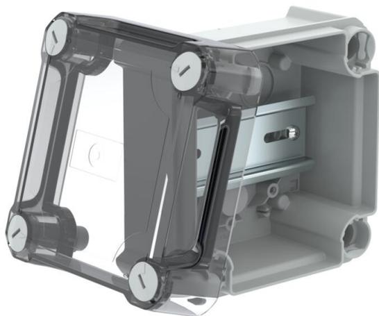
Kabelabzweigkasten geschlossen zum Verbinden von Kabeln und Leitungen im Innenbereich und geschützten Außenbereichen. Quadratische Form ohne Einführungen. Geeignet für die Wand-/ Deckenmontage und die Montage auf Montageblechen. Mit der Möglichkeit zur Innenbefestigung und Montage über die Eckdome. Hoher, transparenter Deckel mit Schnellverschluss, plombierbar. Hergestellt aus halogenfreien und UV-resistenten Materialien. Inklusive Hutprofilsschiene.
