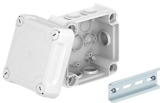
Kabelabzweigkasten zum Verbinden von Kabeln und Leitungen im Innenbereich und geschützten Außenbereichen. Quadratische Form mit Einsteckdichtungen an den Seiten und Ausschlageinführungen im Boden. Geeignet für die Wand-/ Deckenmontage und die Montage auf Montageblechen. Mit der Möglichkeit zur Innenbefestigung und Montage über die Eckdome. Hoher Deckel mit Schnellverschluss, plombierbar. Hergestellt aus halogenfreien und UV-resistenten Materialien.
