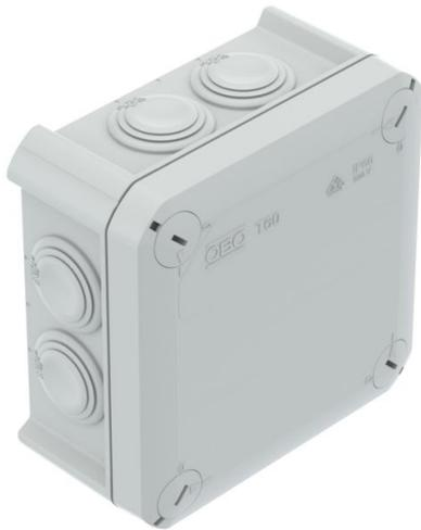
Kabelabzweigkasten zum Verbinden von Kabeln und Leitungen im Innenbereich und geschützten Außenbereichen. Quadratische Form mit Einsteckdichtungen an den Seiten und Ausschlageinführungen im Boden. Geeignet für die Wand-/ Deckenmontage und die Montage auf Montageblechen. Mit der Möglichkeit zur Innenbefestigung und Montage über die Eckdome. Deckel mit Schnellverschluss, plombierbar. Hergestellt aus halogenfreien Materialien. Flammwidrige Ausführung aus speziellem Polypropylen.
