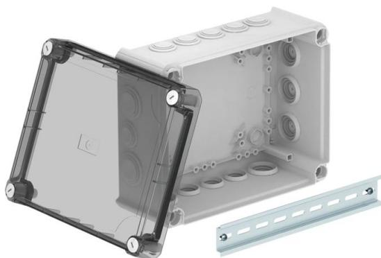
Kabelabzweigkasten zum Verbinden von Kabeln und Leitungen im Innenbereich und geschützten Außenbereichen. Rechteckige Form mit Einsteckdichtungen an den Seiten und Ausschlageinführungen im Boden. Geeignet für die Wand-/ Deckenmontage, die Montage auf Montageblechen und Gewinde im Boden. Mit der Möglichkeit zur Innenbefestigung und Montage über die Eckdome. Hoher, transparenter Deckel mit Schnellverschluss, plombierbar. Hergestellt aus halogenfreien und UV-resistenten Materialien.
