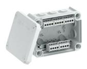
Kabelabzweigkasten mit Klemmleiste zum Verbinden von Kabeln und Leitungen im Innenbereich und geschützten Außenbereichen. Rechteckige Form mit Einsteckdichtungen an den Seiten und Ausschlageinführungen im Boden. Geeignet für die Wand-/ Deckenmontage und die Montage auf Montageblechen. Mit der Möglichkeit zur Innenbefestigung und Montage über die Eckdome. Deckel mit Schnellverschluss, plombierbar. Hergestellt aus halogenfreien und UV-resistenten Materialien.
