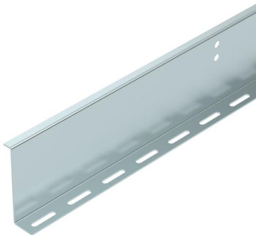
Trennsteg für das begehbare Kabelrinnen-System BKRS. Befestigung mit Flachrundschauben M 6 x 12 mm in der Bodenlochung.
