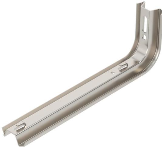
TP-Ausleger mit Klemmlaschen zur schraubenlosen Gitterinnenbefestigung. Wird der Ausleger direkt an der Wand befestigt oder werden die Profile gegeneinander geschraubt, so ist aus Stabilitätsgründen immer das Distanzstück Typ DS 4 einzusetzen. Auf dem TP-Ausleger können Gitterrinnen mit der Maschenweite 50 x 100 mm z. B. Typ GRL, GR und GRM schraubenlos befestigt werden.
