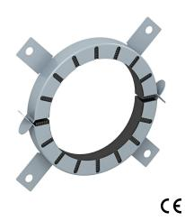
Rohrmanschette für brennbare Rohre. Im Stahlblechgehäuse eingefasste Brandschutzeinlagen drücken im Brandfall die abbrennenden thermoplastischen Rohre mit sehr hohem Blähdruck zu. Anwendung im Innenbereich. Befestigung mit Dübeln oder Gewindestangen M6 bis Größe 75, danach M8.
