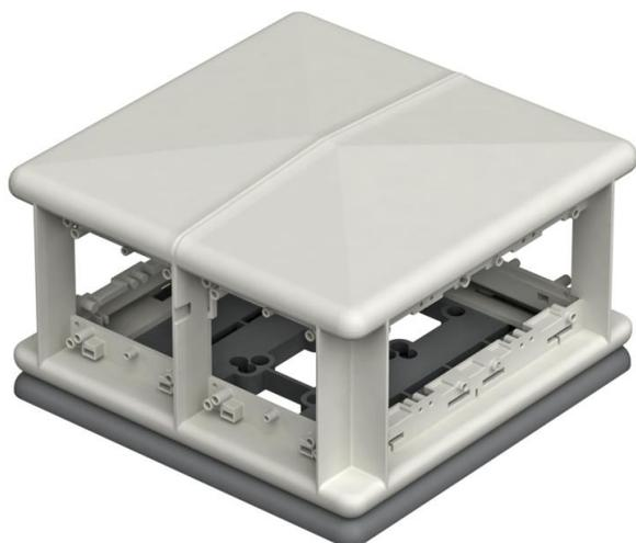
Fußbodenübertagende Einbaueinheit für den Einbau von 8 einzelnen Installationsgeräten mit Tragering oder -bügel auf 4 Seiten. Die Trennung der Stromarten (4 + 4) erfolgt mittels einer Trennwand. Bei Verwendung von Mehrfach-Installationsgeräten kann die Anschlusskapazität erhöht werden. Schraubbefestigungsspur für Installationsgeräte: 60 mm senkrecht.
