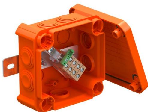
Kabelabzweigkasten mit keramischen Einzelklemmen und weichen Einsteckdichtungen. Ausreichender Verdrahtungsraum durch diagonal angeordnete Anschlusseinheit mit komplett vormontierten hochoberflächenbeständigen Keramik-Klemmen. Grün-Gelb gekennzeichnete Schutzleiterklemme. Befestigung an gut zugänglichen Außenlaschen. Zugelassen für Kabelanlagen mit elektrischem Funktionserhalt nach DIN 4102 Teil 12 mit den Klassen E30, E60 und E90. Keramik-Klemmen wurden nach DIN EN 60998-2-1:2004 geprüft.
