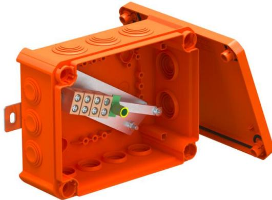
Verbindungskasten mit weichen Einsteckdichtungen. Ausreichender Verdrahtungsraum durch diagonal angeordnete Anschlusseinheit mit komplett vormontierten hochtemperaturbeständigen Keramikklemmen. Grün-gelb gekennzeichnete Schutzleiterklemme. Befestigung an gut zugänglichen Außenlaschen. Zugelassen für Kabelanlagen mit elektrischem Funktionserhalt nach DIN 4102 Teil 12 mit den Klassen E30, E60 und E90. Keramikklemmen wurden nach DIN EN 60998-2-1:2004 geprüft.
