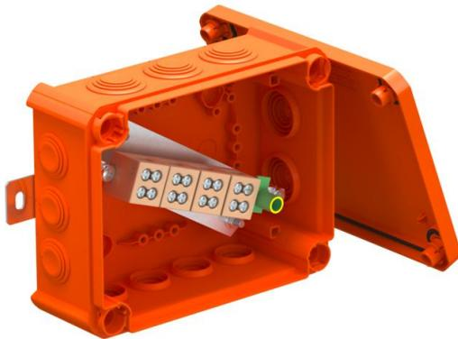
Kabelabzweigkasten mit keramischen Doppelklemmen und weichen Einsteckdichtungen. Ausreichender Verdrahtungsraum durch diagonal angeordnete Anschlusseinheit mit komplett vormontierten hohtemperaturbeständigen Keramik-klemmen. Grün-gelb gekennzeichnete Schutzleiterklemme. Befestigung an gut zugänglichen Außenlaschen. Zugelassen für Kabelanlagen mit elektrischem Funktionserhalt nach DIN 4102 Teil 12 mit den Klassen E30, E60 und E90. Keramik-klemmen wurden nach DIN EN 60998-2-1:2004 geprüft.
